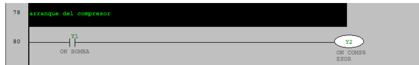
Figura. Activación del compresor.
