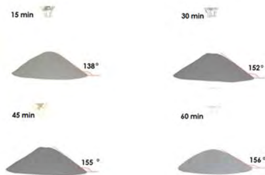
Figura 6. Angulo de reposo de partículas de pilas de NiMH a) sin procesar, b) procesada a 15 min, c) 30 min, d) 45 min, e) 60 min
