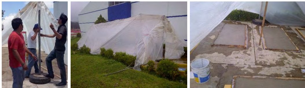
Figura 3. Túnel de secado para bloques de papel.
