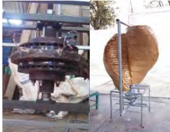
Figura 7. Generador eléctrico montado en su base y ensamble con la álabe para formar el aerogenerador vertical Fuente: Propia.
