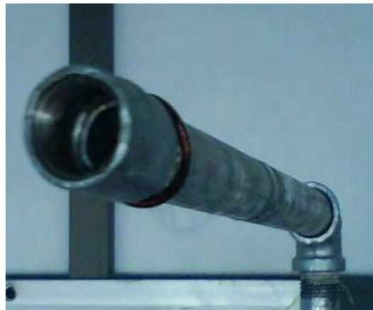
Figura 5. Tubo galvanizado.
