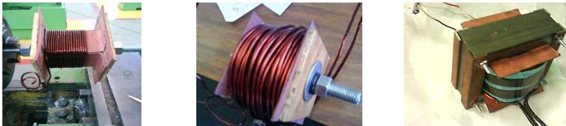
Figura 6. Etapas de Fabricación del transformador.
