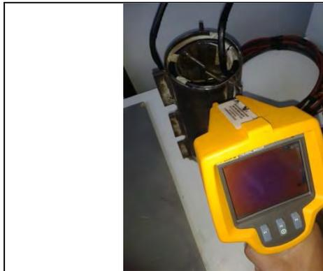
Figura 17. Medición de la temperatura en los tubos didipadores.
