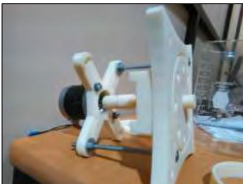
Figura 4. Soporte para motor montado en la tapa.
