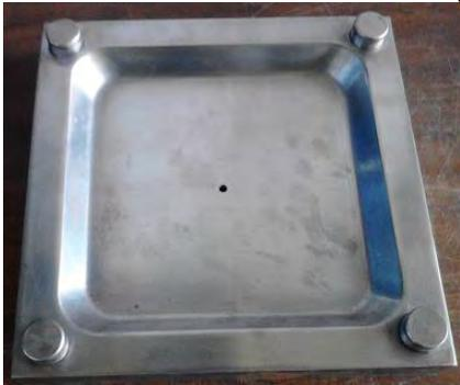
Figura 16 Cavity de charola manufacturada mediante la estrategia de maquinado paralelo
