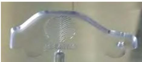
Figura 20 Cavity de llavero fabricada con la estrategia de paredes anguladas
