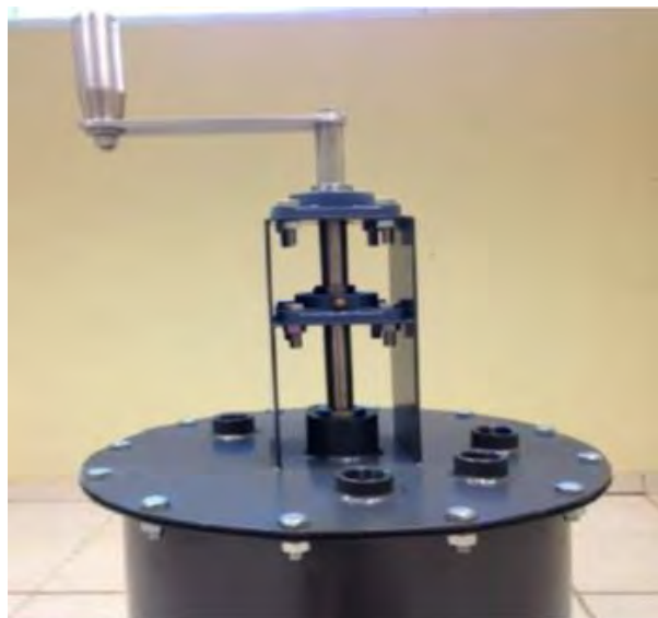
Figura 5. Puertos en la tapa del biorreactor
