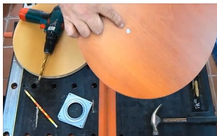
Ilustración 4. Perforar con una mecha más grande.
