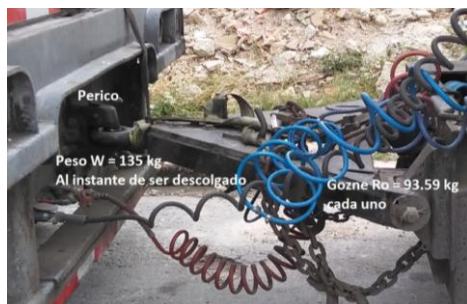
Figura 6. Distribución de cargas en lanza de acoplamiento
