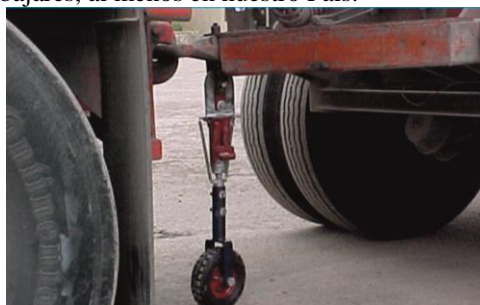
Figura 2. Patín de Dolly Mecánico (Primera edición)
