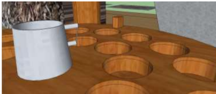
Figura 9. Mesa con compartimentos para los nuevos moldes.
