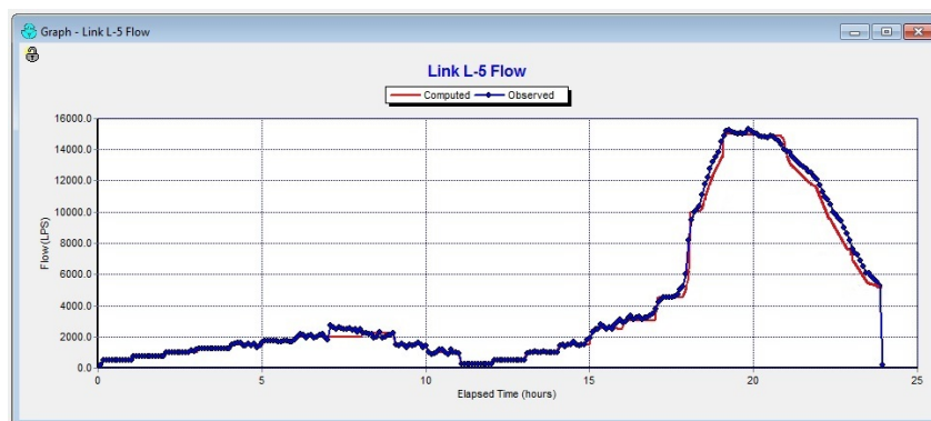
Figura 5. Curva de calibración entregada por SWMM.
