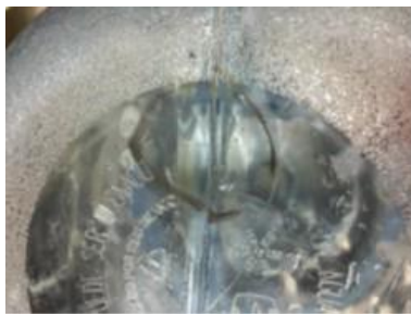
Fig. 6. Fisura de garrafón
