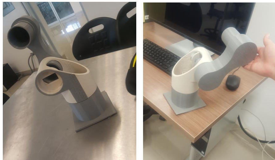
Figura 3 Dos vistas del armado de las piezas del prototipo elaboradas en impresora 3D.
