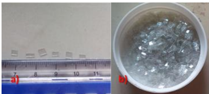
Figura 1. PET de botellas recortado en pedazos de 3 a 4 mm.
