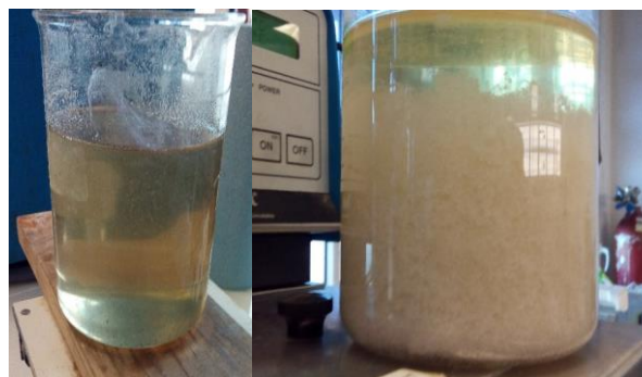
Figura 3. Productos después de salir del reactor y después de enfriar, se observó separación de fases.
