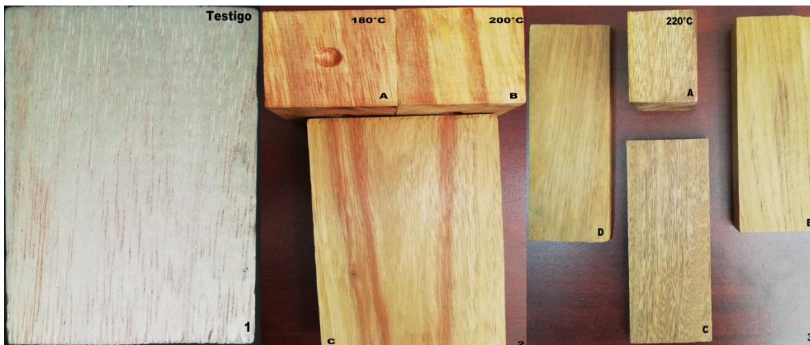
Figura 3: Cambio de coloración de la madera de Acrocarpus fraxinifolius después de ser tratada a 180, 200 y 220°C y su parecido con otras maderas: 1) Testigo, 2) A y B la madera tratada a 180 y 200°C y C madera de Terminalia amazonia similar a la madera tratada. 3) A, madera tratada a 220°C, B, C y D maderas de Tectona grandis , Vatairea lundelli y Lysiloma latilissiquum similares a la madera tratada a 220°C.
