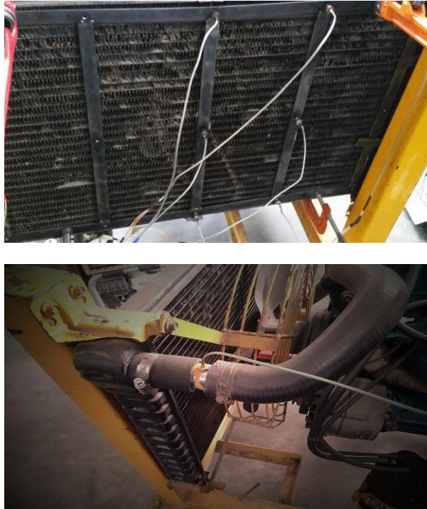
Figura 1. Radiador empleado para el presente estudio. Arriba: detalle de la instrumentación usando termopares; Abajo: detalle de la instrumentación para registrar la temperatura del agua de entrada.
