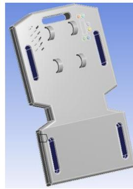
Figura 12. Colocación de soportes fijos en las caras
