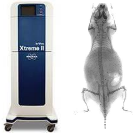
Figura 2. Adquisición de imágenes radiográficas con equipo In Vivo Xtreme II. La figura derecha muestra las imágenes digitales de rayos X.
