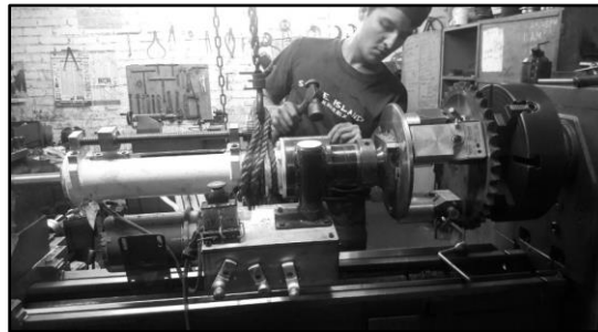
Figura 1. Montaje del torno portátil para realización de prueba en maquinado interno de corona dentada.
