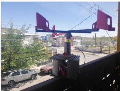
(Ensamble del prototipo en Solidworks. Fig. 2) (Prototipo de la estación meteorológica. Fig 3)
