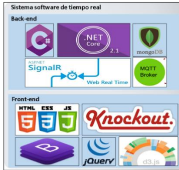
Figura 5. Pila de tecnologías utilizadas en el desarrollo de la aplicación web del sistema SCADA
