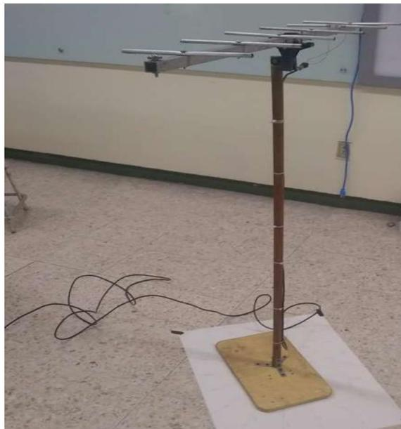
Figura 8. Antena construida y hoja para generar el patrón de radiación.
