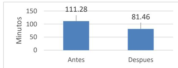
Figura 6. Tiempos promedio de cambio de molde antes y después de la aplicación del SMED
