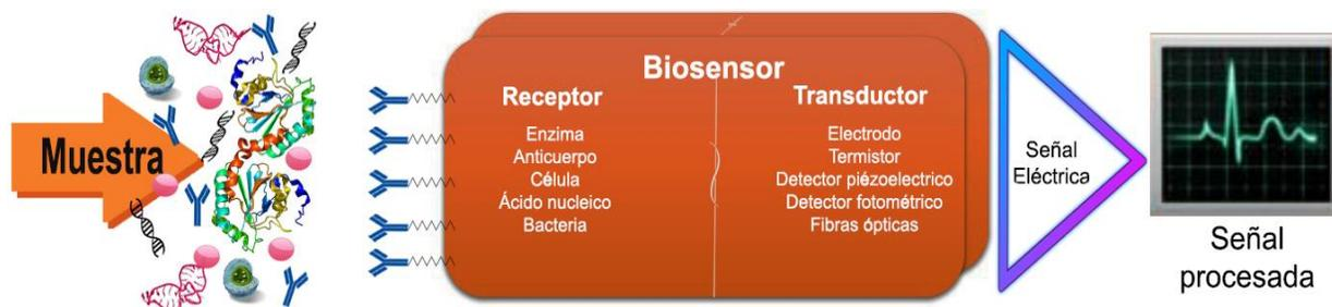
Figura 1. Esquema general de un biosensor.
