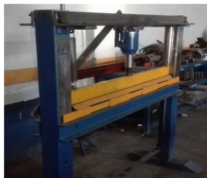
Figura 10. Dobladora de lámina
