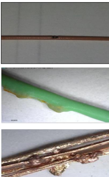
Figura 1 Defectos en la extrusión de cable.
