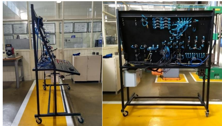
Figura 9. Vista lateral y posterior del banco electro neumático.
