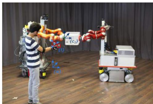
Figura 3. Preparación experimental con cuatro manipuladores robóticos KUKA LWR 4+ y un experto humano equipado con un conjunto de dispositivos hápticos (marcados con círculos rojos). El efector final \{r\} , dispositivo háptico \{t\} , y marcos de referencia \{w\} , se muestran en azul. (Musi et al., 2017)
