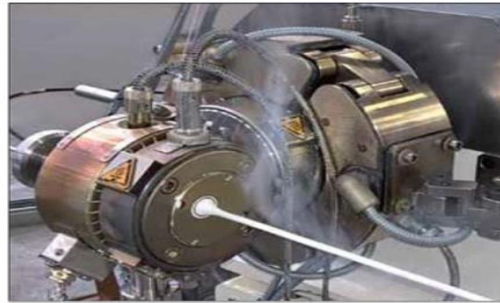
Figura 2. Extrusión de cable.
