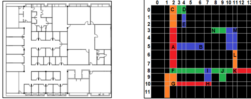
Figura 4: Mapa del edificio de prueba y su cuadrícula, utilizada para los algoritmos de trazado de ruta.
