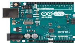
Figura 1 Microcontrolador ATMEGA238 de Atmel encapsulado en placa de desarrollo Arduino Uno
