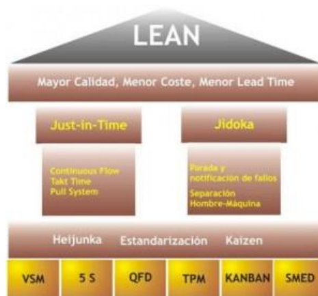
Fig. 2 Las 8 herramientas de Lean. Fuente: Lazala Rosario N. Lean Manufacturing y sus herramientas.
