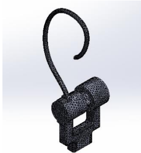
Figura 4. Resultado del mallado en la carcasa del prototipo (Aguilar Rodríguez, et al., 2016).
