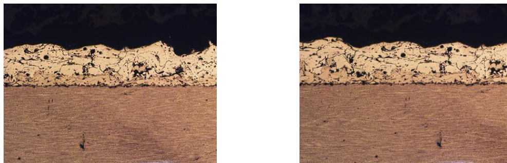
Figura 4. Muestra IPI 1 con revestimiento identificado como 595AS (Fe-Cr-B-Si-Mn-C). Nital 5% 50X
