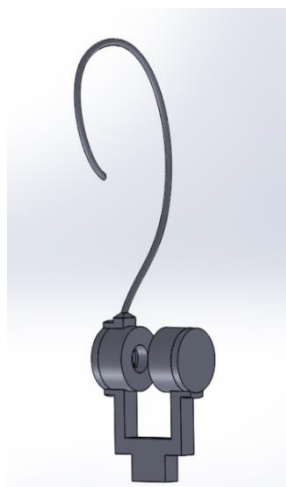
Figura 2. Diseño de carcasa para un sistema transdérmico para medir glucosa en la oreja izquierda en Solidworks (Aguilar Rodríguez, et al., 2016).
