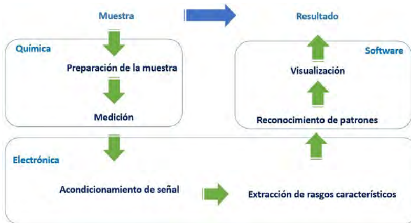
Figura 5. Estructura de una nariz electrónica.
