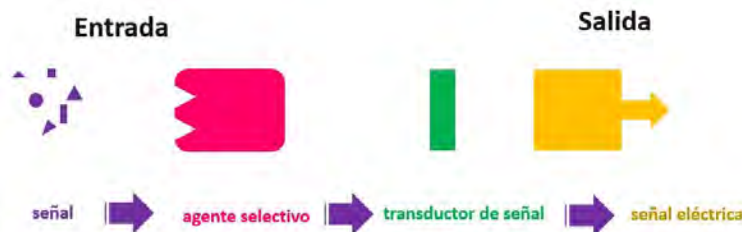
Figura 6. Etapas de procesamiento de señales en sensores de gas.
