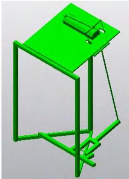
Figura 5. Diseño en autoCAD de la termoselladora.
