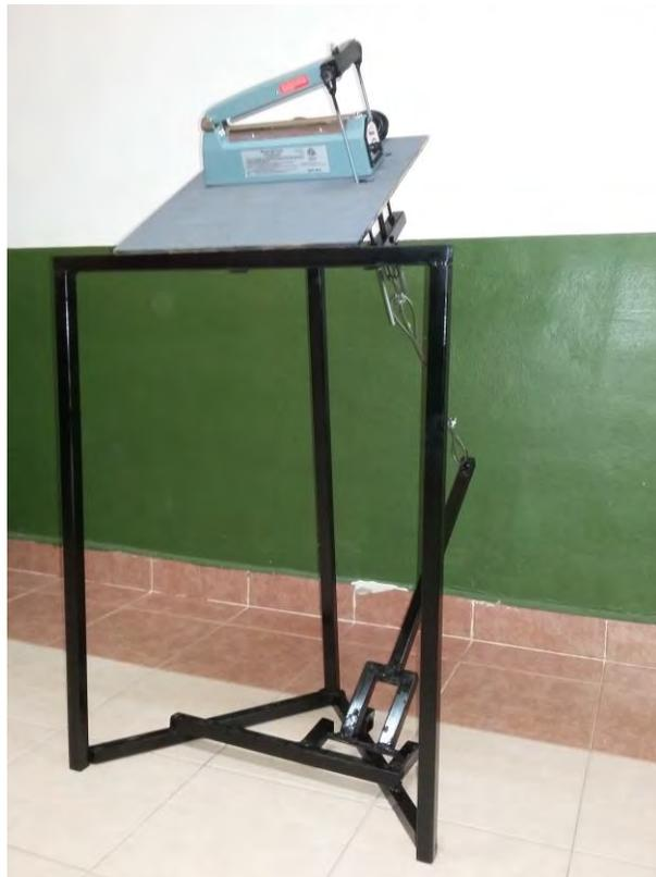
Figura 6. Prototipo de la termoselladora.
