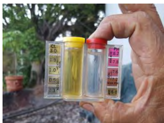
Foto 1. Equipo de Medición de cloro residual
