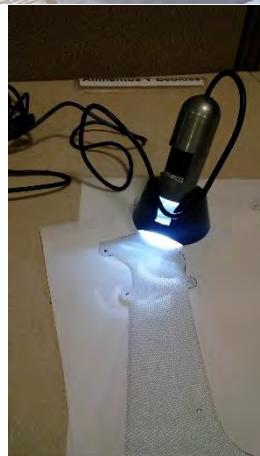
Figura 6 Mediciones del denier contra el plot (diseño original de la pieza del denier) con DinoCapture .
