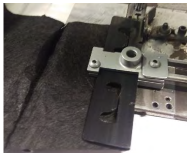
Figura 11. Poka yoke de retenedor.
