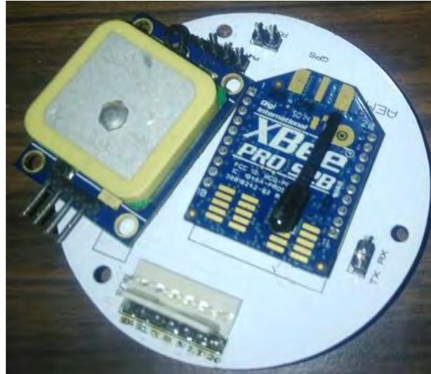
Figura 3. Módulo de telemetría.
