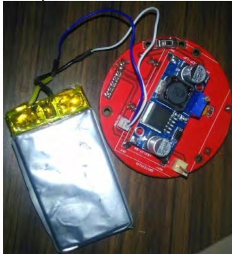
Figura 2. Módulo de potencia.
