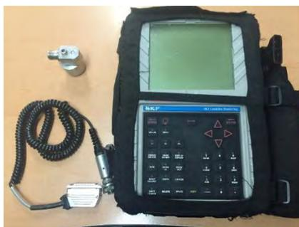
Figura 2. Analizador de vibraciones Microlog CMVA55 y acelerómetro SKF CMSS2200.
