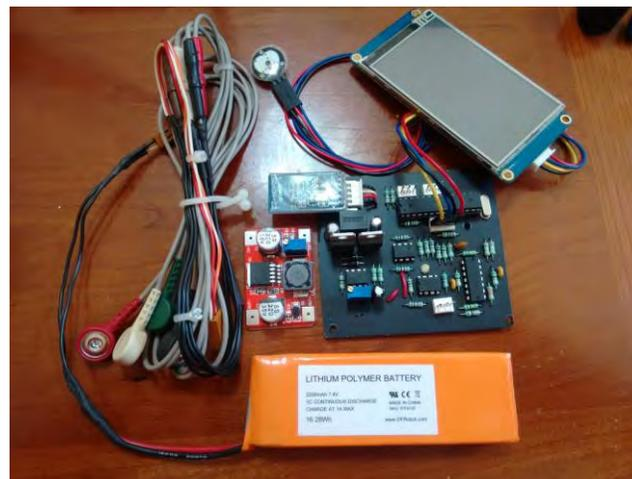
Figura 2. Circuito electrónico del monitor de signos vitales inalámbrico.
