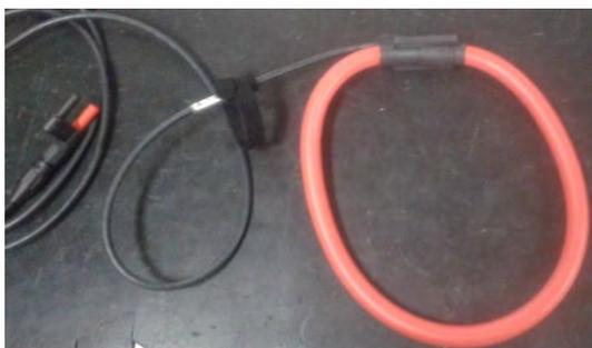
Figura 3. Variante de Pinza Amperimétricas
