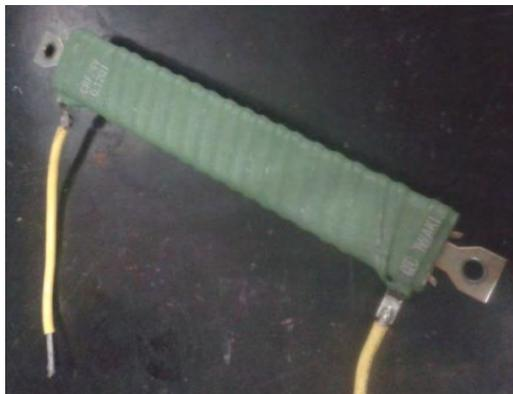
Figura 1. Resistencia Shunt
