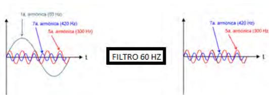
Figura 6. Filtrado de la componente fundamental
