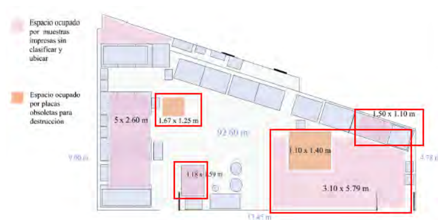
Figura 1. Layout almacén de pre prensa, elementos obsoletos: placas y muestras impresas, espacio que representa 38.08 m 2 , espacio ocupado que se busca reducir en al menos un 60%
