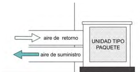
Figura 1.2 Detalles de descarga horizontal
