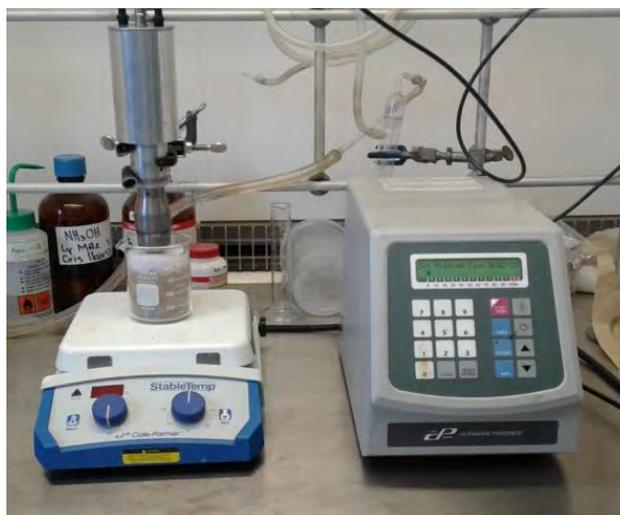
**Figura 1.** Sistema con punta de ultrasonido
