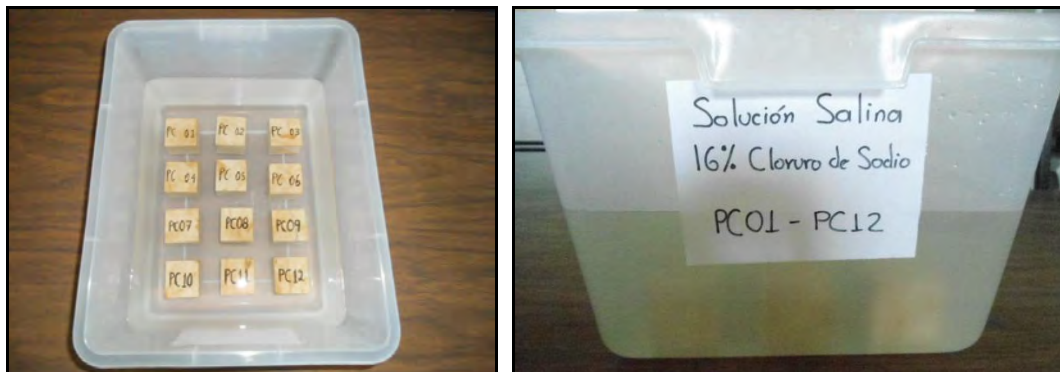
Figura 7. Fotografía de las 12 probetas inmersas en solución salina de cloruro de sodio al 16%
