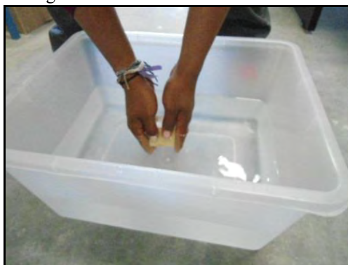
Figura 9. Fotografías del lavado con agua destilada de las 12 probetas
