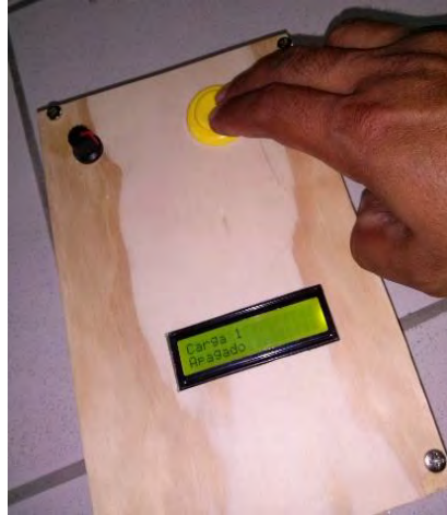
Figura 5. Módulo emisor para enviar las instrucciones de control al PLC.
