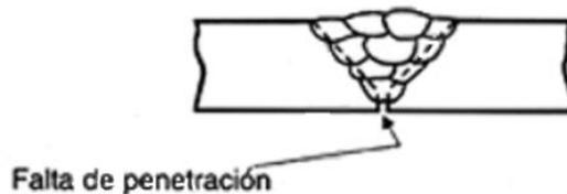
Figura 7 Falta de penetración en la raíz
