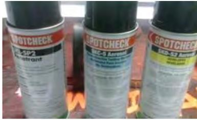
Figura 3 líquidos penetrantes en aerosol
