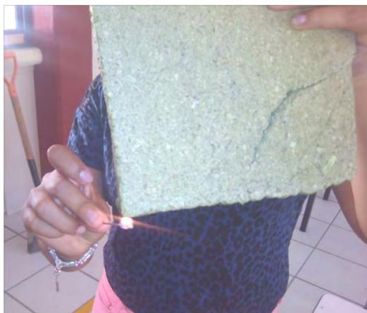
Figura 2. Prueba de combustión de ECOPLAF
