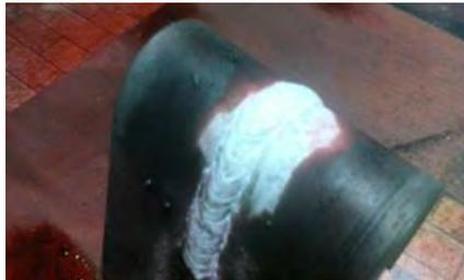
Figura 4 Probeta con líquidos penetrantes
