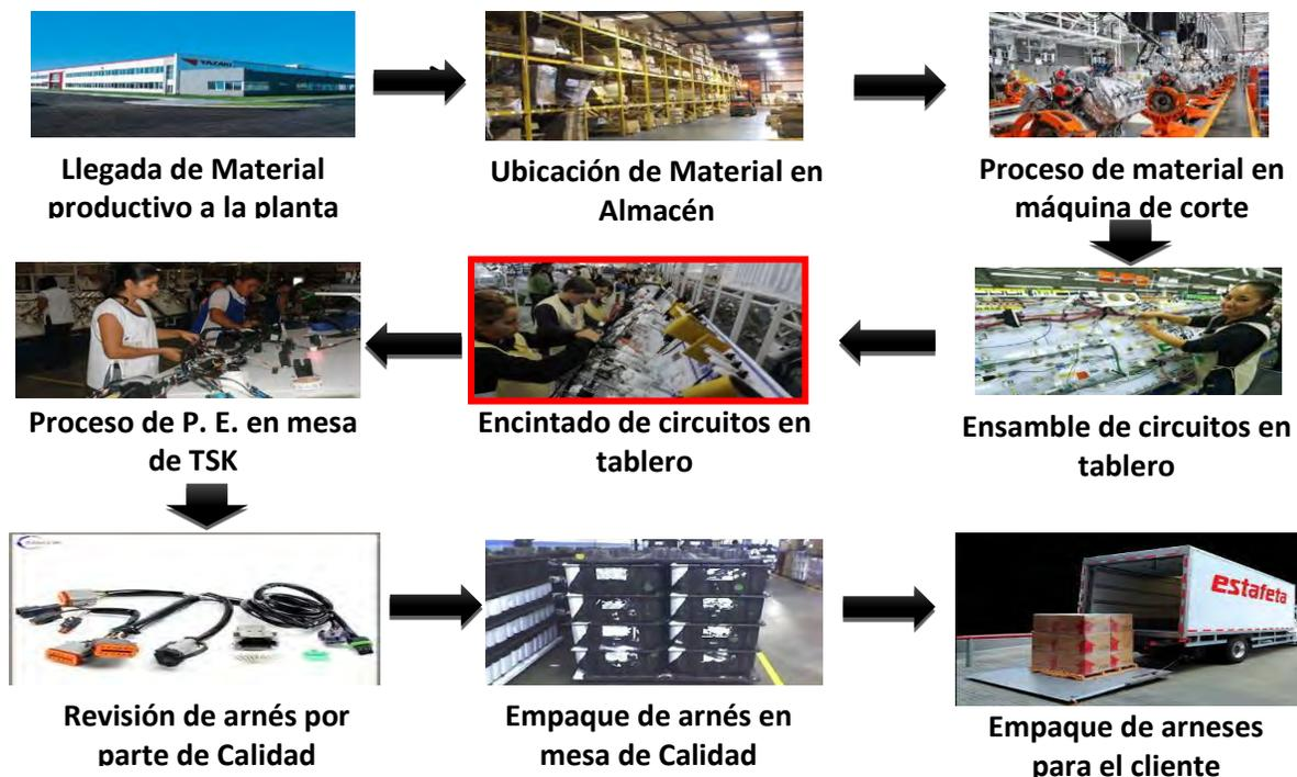
Figura 3.- Proceso general de fabricación de un arnés
