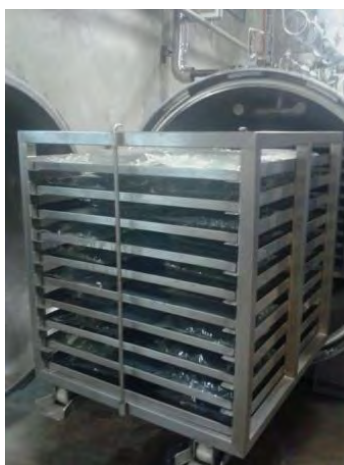
Figura 2. Carros de acero inoxidable para la colocación de productos dentro de la autoclave.
