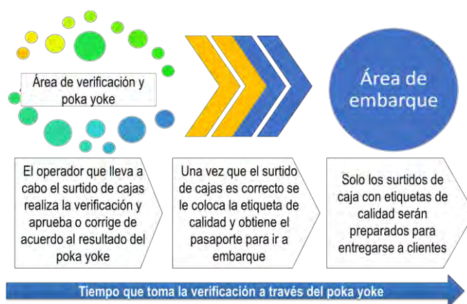
Figura 4 Proceso de verificación de surtido de cajas después utilizando el sistema poka yoke
