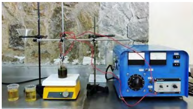
Figura No. 2. Montaje del equipo Kasselco para electrocoagulación
