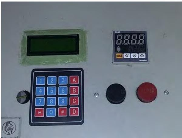
Figura 2. Temporizador y control de temperatura.
