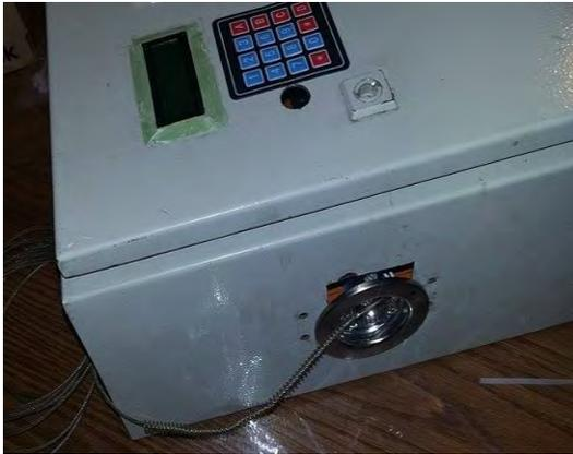
Figura 3. Conexión de la sonda de temperatura.
