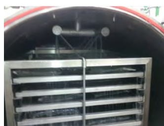
Fig. 2. Entrada de agua para enfriamiento.
