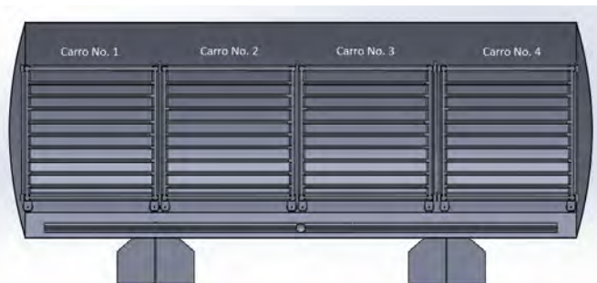
Fig. 3. Ubicación de los carros en el interior de la autoclave.
