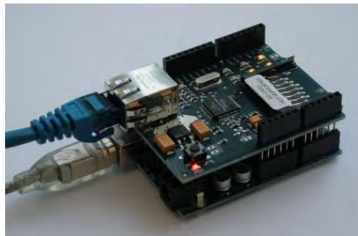
Figura 7. Shield Ethernet montada en una Tarjeta Arduino Uno.
