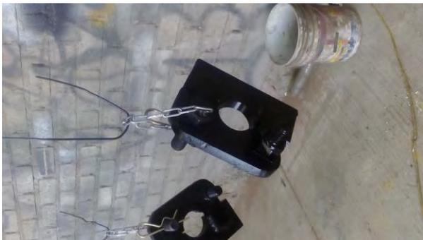
Figura 9. Sujetador de cable 440v (pacman).
