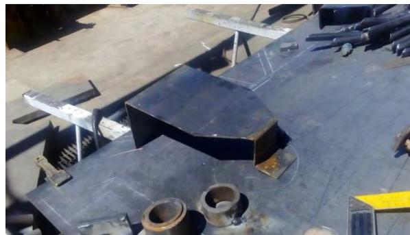
**Figura 10.** Protecciones para cilindros de levante. **Figura 11.** Protección para madrazas de mangueras y conexiones.
