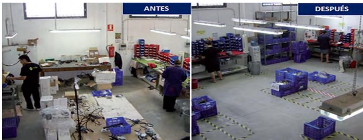
Fig.5 Área de trabajo antes y después de aplicar las 5'S
