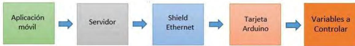
Figura 1. Diagrama a bloques de las partes que conforman el Sistema Domótico
