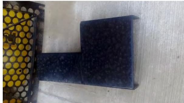
Figura 7. Protección de válvulas de unidad de giro.
