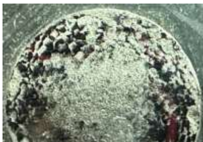
Figura 5. Fotografía en donde se aprecia visualmente la modificación superficial del sustrato.
