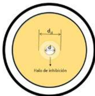
Figura 1. Medidas para el halo de inhibición antimicrobiano. En la imagen se muestra una imagen representativa de una caja de Petri, el diámetro de la zona de inhibición ( d_{zi} ) y el diámetro del pozo o biopelícula en la que se agregó el agente antimicrobiano.
