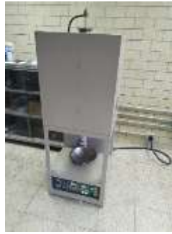
Figura 2. Horno tubular, el cual cuenta con una cámara que se llena de gas inerte.
