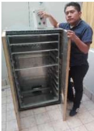
Figura 5. Prototipo de deshidratador para hierbas medicinales con quemador de gas LP terminado
