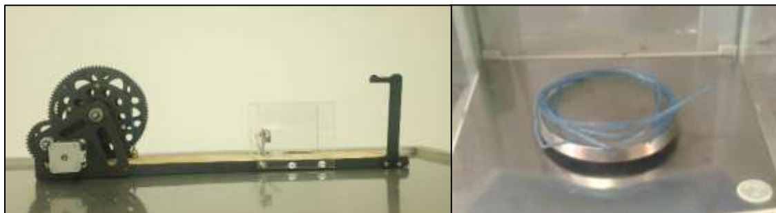
Figura 5. Prototipo SEER y filamento confeccionado con envases PET. Elaboración propia.
