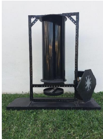
Figura 1: Prototipo de un Aerogenerador de Eje Vertical Modelo Savonius nombrado SV-01, elaboración propia.
