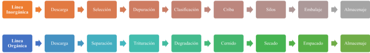
Figura 1. Líneas de procesamiento de los RSU para la PTRSU.
