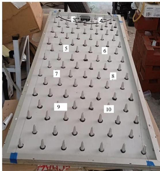
Figura 7 Termopares en aletas
