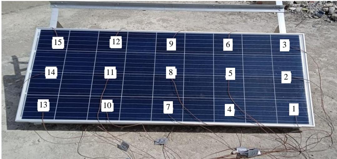
Figura 1 Posición de termopares para adquirir datos.
