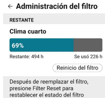
Figura 5. Sistema que permite identificar el porcentaje de efectividad del filtro, en donde 100% significa que el filtro esta en las mejores condiciones y 0% que el filtro debe ser reemplazado.
