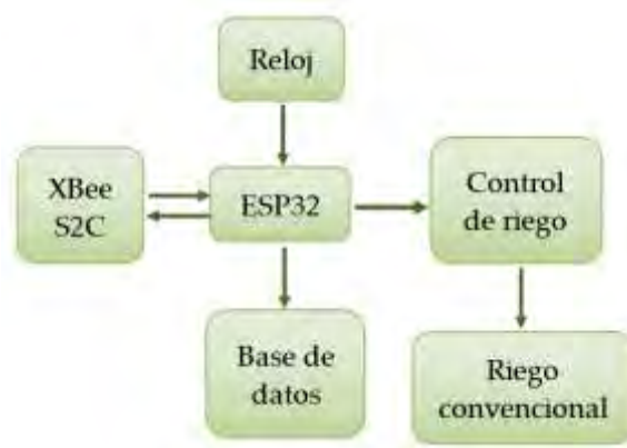
Figura 6. Diagrama a bloques para el flujo de la señal en el módulo de control.
