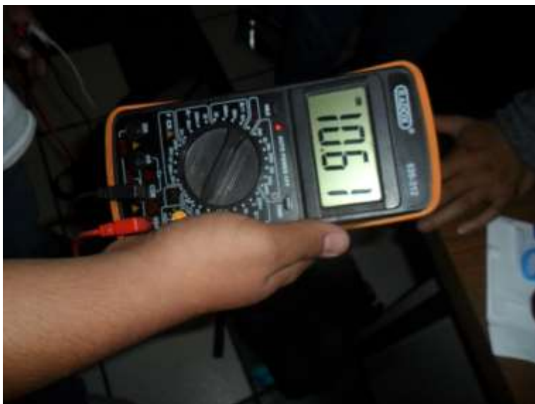
Figura 6 Comprobación del voltaje generado en corriente alterna
