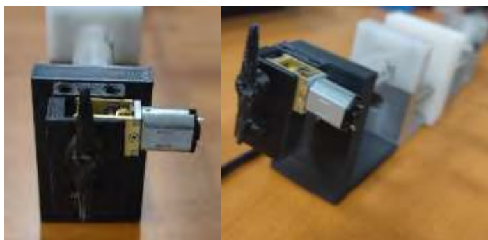
Figura 4. Prototipo del dado de extrusión con el cortador.
