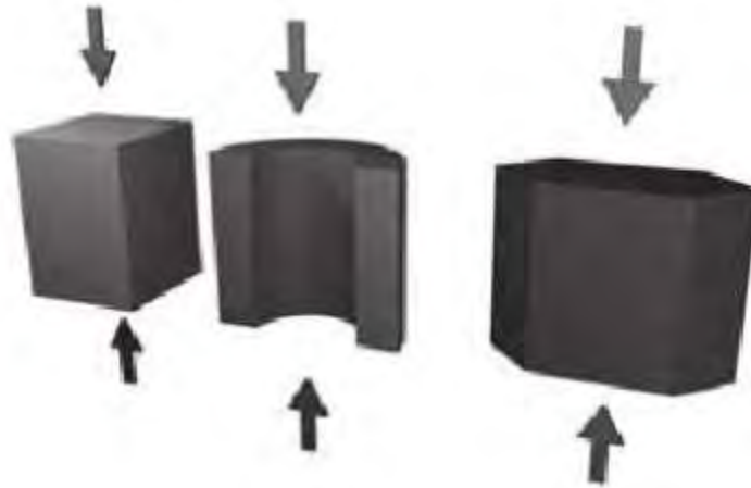
Figura 2 Geometría para sensores piezoeléctricos para fenómeno transversal
