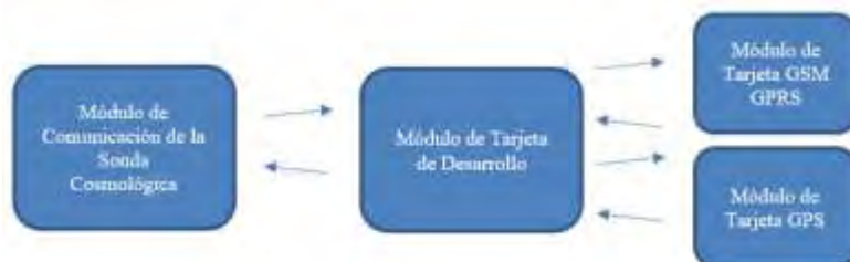
Figura 4. Diagrama de la comunicación entre los módulos del sistema integrado a la sonda cosmológica.
