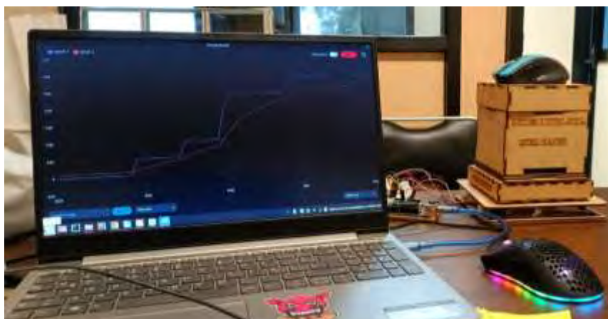
Figura 2. Prototipo de pruebas conectado a PC para registro de mediciones de peso.
