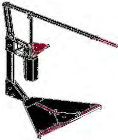
Figura 1. Estructura de inyectora de plástico
