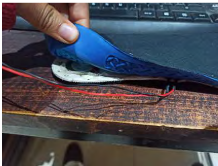
Figura 13 Plantilla con los componentes instalados
