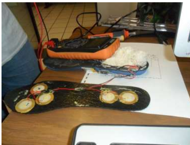
Figura 5 Conexión de sensores piezoeléctricos
