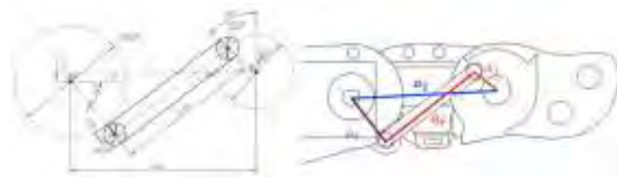
Figura 5. Mecanismo de 4 barras de la falange medial
