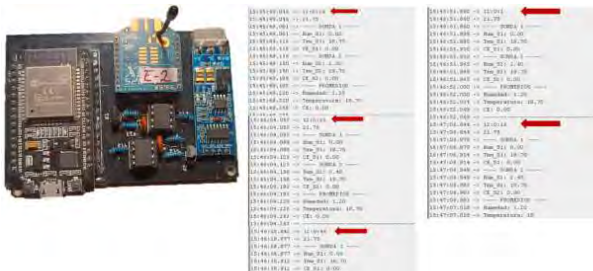
(a) Módulo: sonda y control (b) Prueba funcional del sistema de monitoreo Figura 8. Prototipo desarrollado para un sistema de monitoreo para riego de precisión en campos agrícolas.
