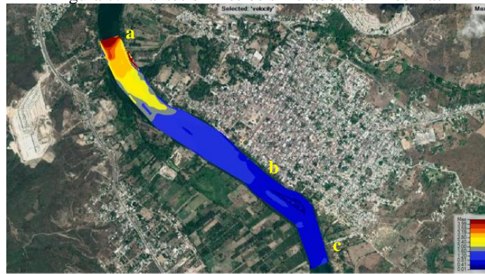
Figura 8. Velocidad en m/s simulados con Hec Ras
