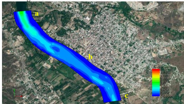
Figura 10. Velocidad en m/s simulados con IRIC
