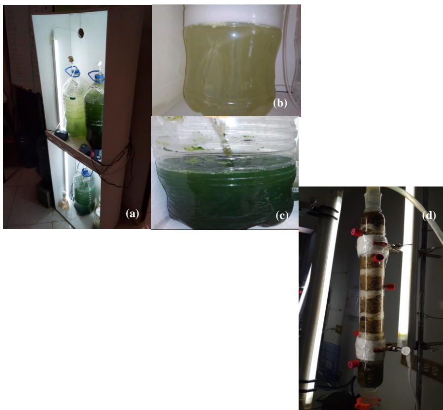
Figura 1. (a) Cultivo en reactores Airlift, (b) adaptación inicial de la cepa al fluoreno, (c) cultivo al final de la aclimatación y (d) sistema de flujo continuo alimentado con medio N8Y.
